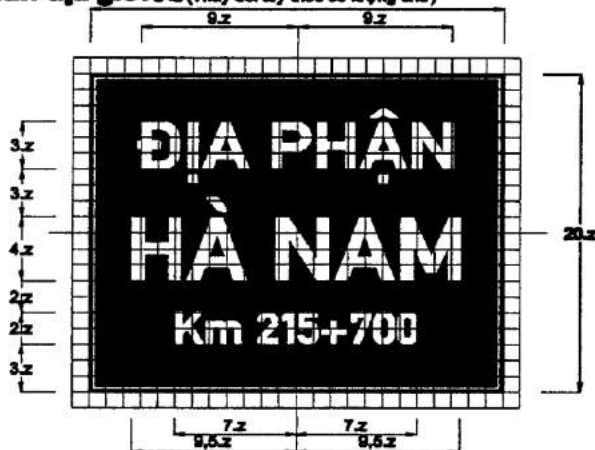
Biển 419b: Chỉ dẫn địa giới trên tuyến đường đối ngoại
